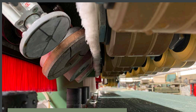
Regolazione smusso con tastatore (optional) Automatic probe (optional) for a perfect chamfer width
